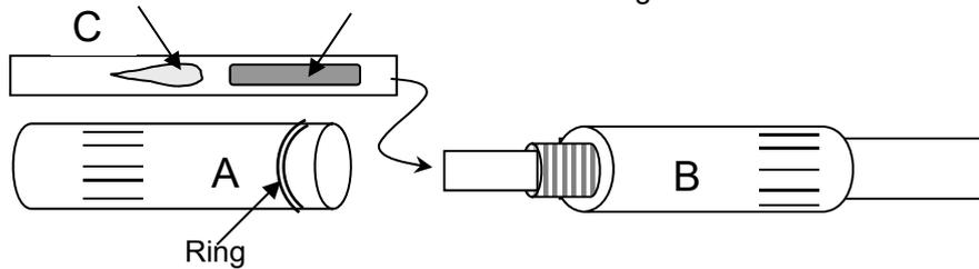
1. FlexiCheck Prüfkörper aufschrauben. Hierzu Teil A mit Ring-Markierung vom Teil B ohne Ring-Markierung abschrauben. (siehe Abbildung)
